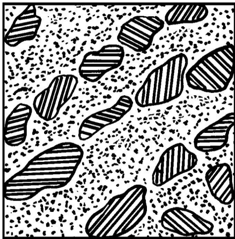
Рисунок 8 – Схема микроструктуры доэвтекктического белого чугуна. Ледебурит и перлит. \times 350
